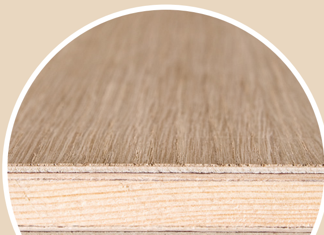
żywic fenolowo-formaldehydowych (ciemna spoina)
