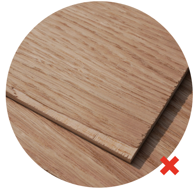
Brak przyklejenia okleiny naturalnej
