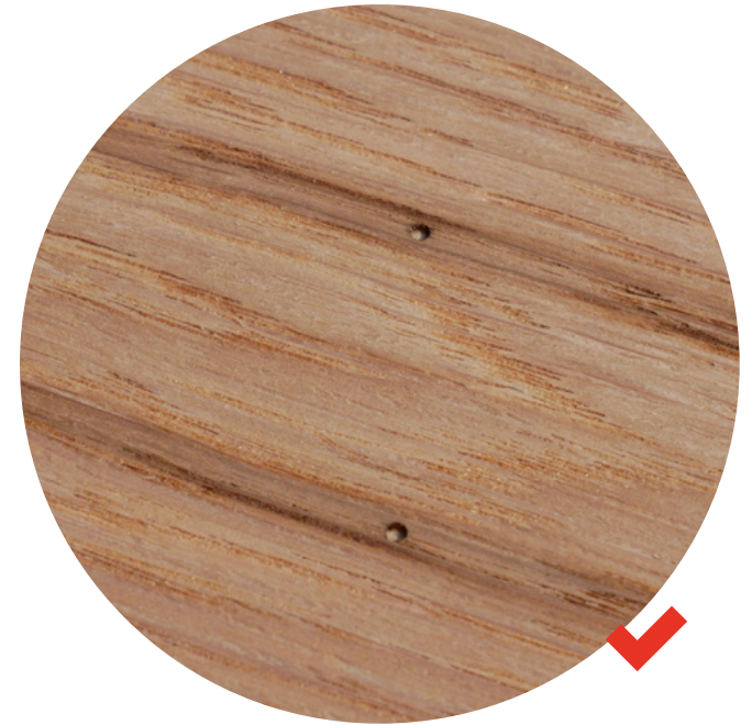
Otwory po sękach, owadach
