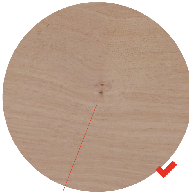
Sęki zdrowe zrosnięte, ciemne kontrastujące z barwą liścia o średnicy do 10 mm
